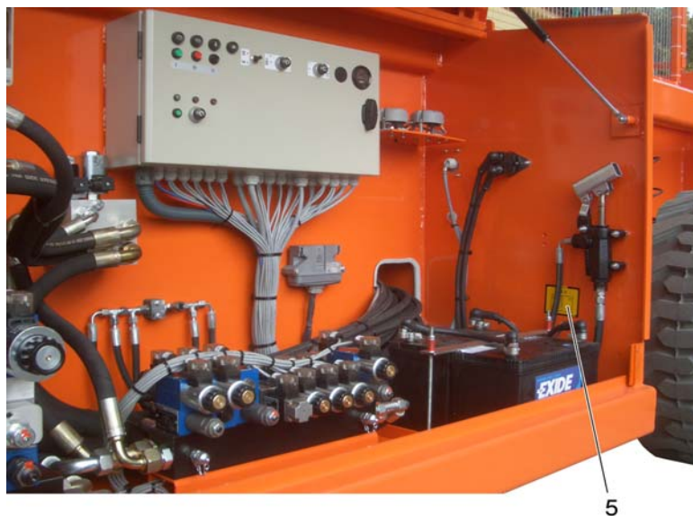
Compartiment des soupapes et compartiment électrique
